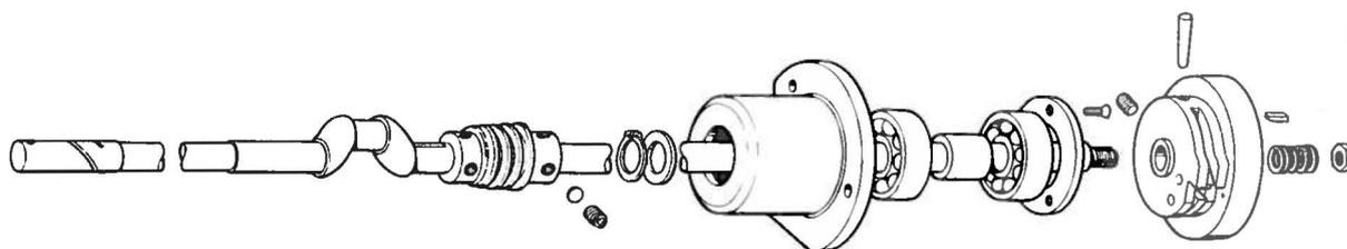
D. 動車・遊車関係 / Drive pulley and idler pulley mechanism / Antriebsriemenscheibe und Riemenscheibe
